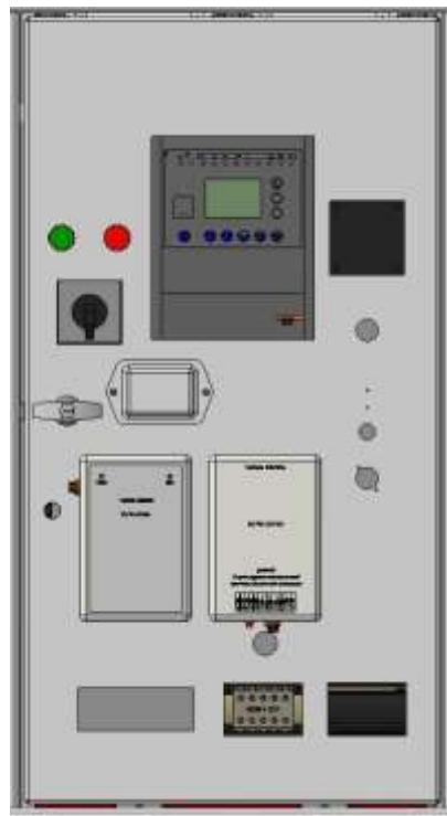
Рис.3. Релейная дверь с аппаратурой защиты и автоматики.
